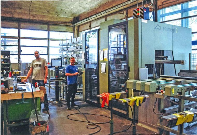
Zum Jahreswechsel wird der Maschinenpark mit einem 15-m-Stubearbeitungszentrum Typ Satellite XTE von Emmegi erneuert.
