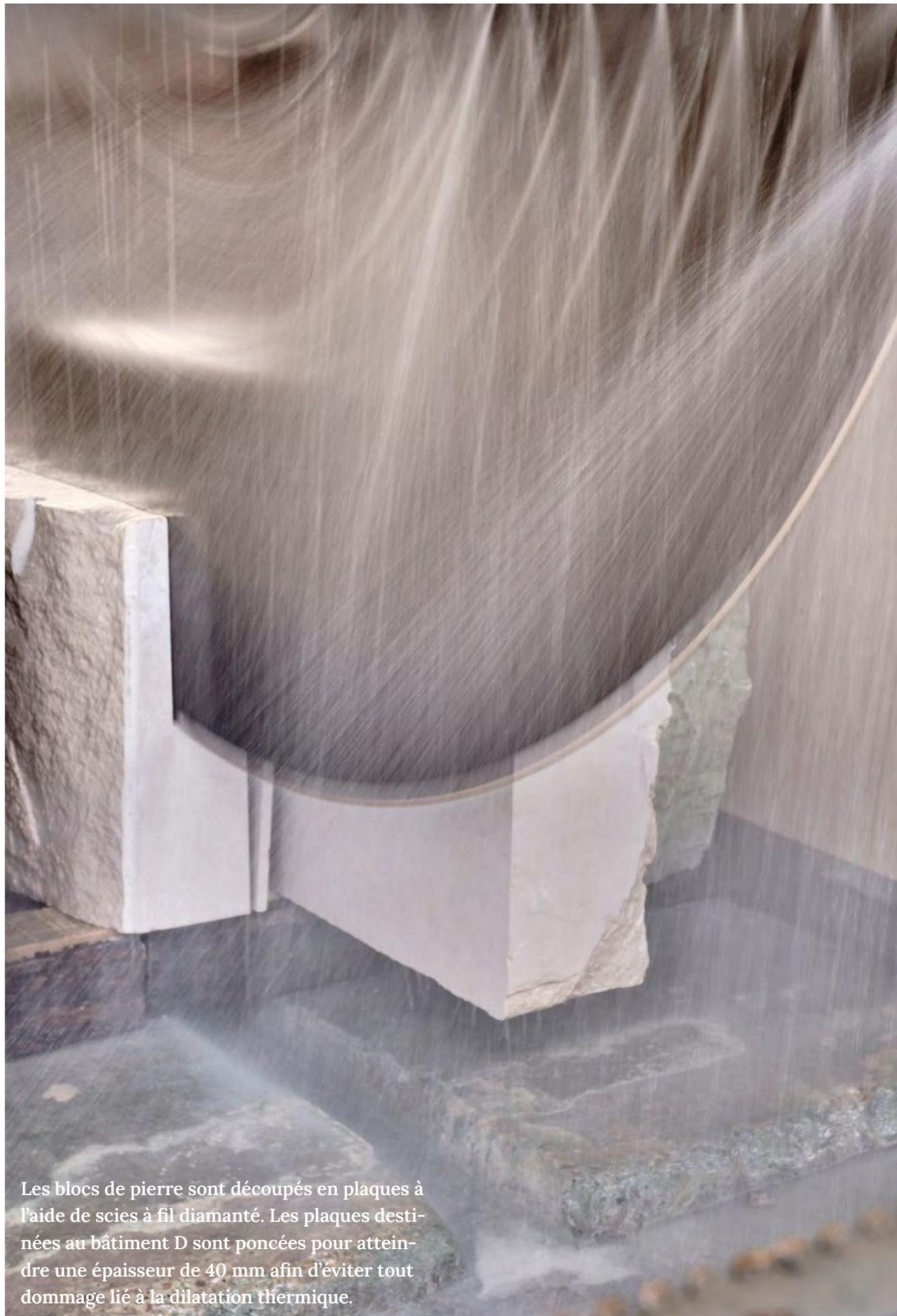
Les blocs de pierre sont découpés en plaques à l'aide de scies à fil diamanté. Les plaques destinées au bâtiment D sont poncées pour atteindre une épaisseur de 40 mm afin d'éviter tout dommage lié à la dilatation thermique.
